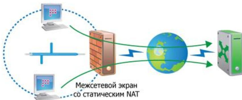
Рисунок 51: Подключение через МЭ со статической трансляцией адресов
