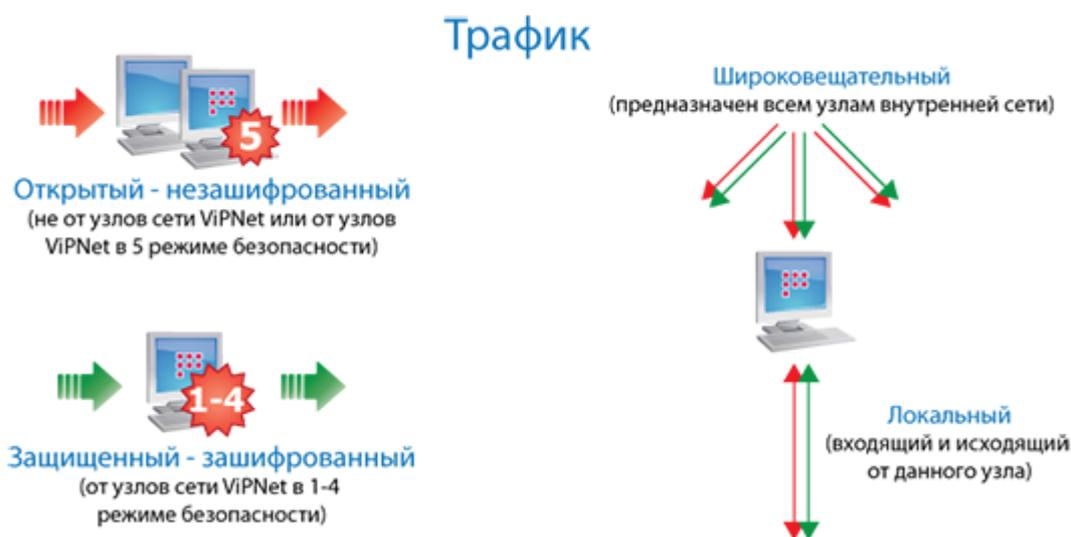
Рисунок 57: Виды трафика, для которых устанавливаются различные правила фильтрации
