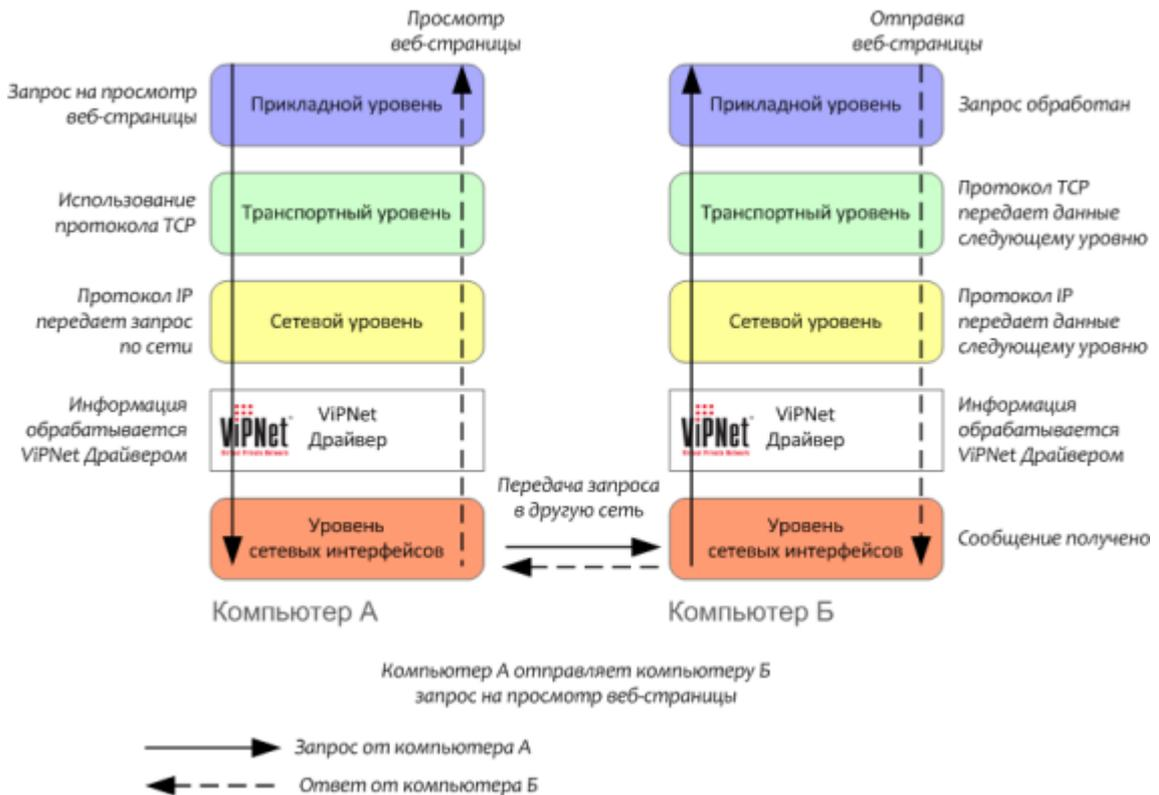
Рисунок 2: Схема работы сети TCP/IP, защищенной ПО ViPNet
