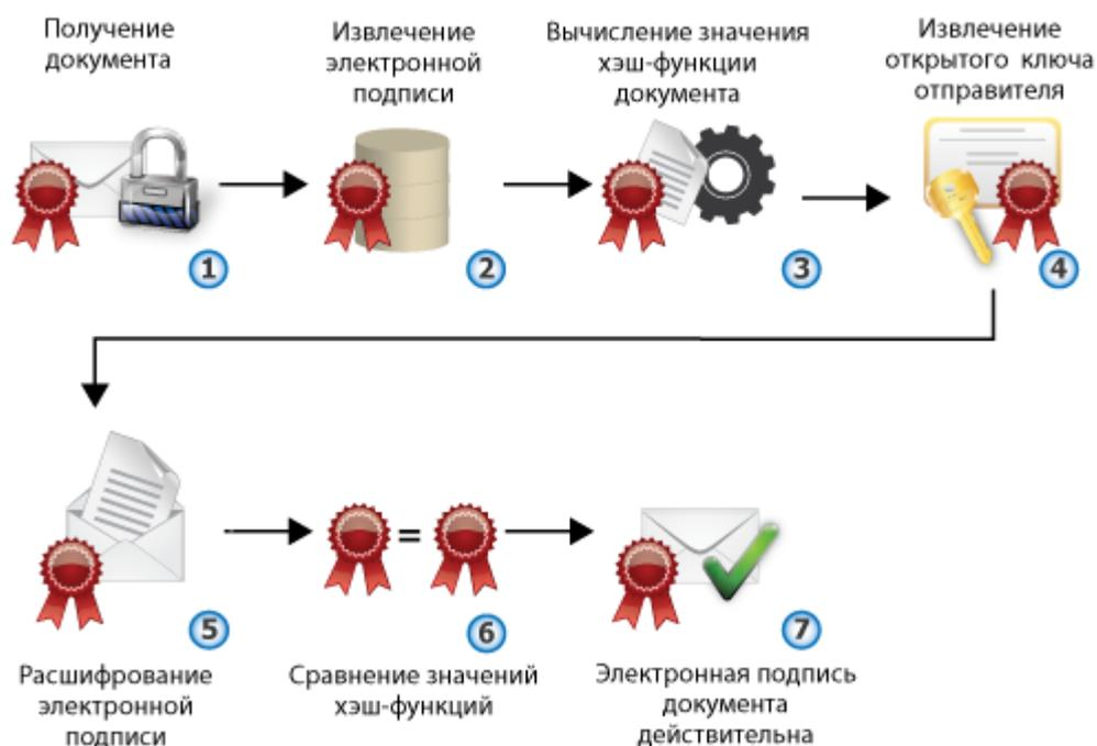
Рисунок 141: Процесс проверки подписи
