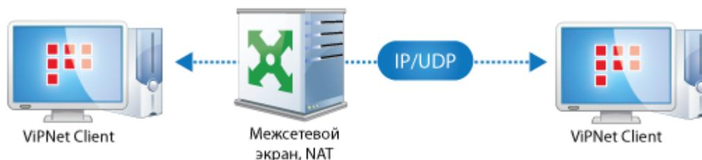
Рисунок 43: Сетевые узлы соединяются через межсетевой экран
